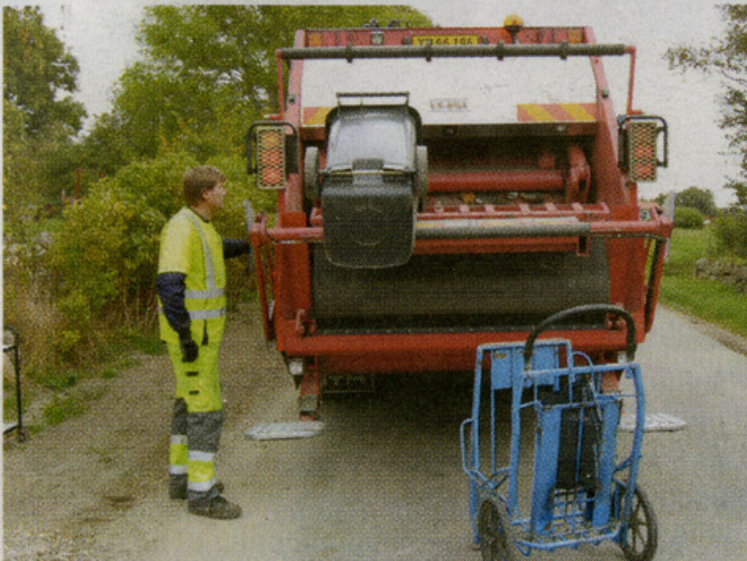
Bilen løfter selv både spande og sækkevogn.
